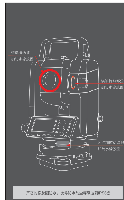
橡胶圈防水原理
