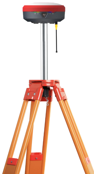
(图 3.3 内置电台 1+1 模式基站架设)
